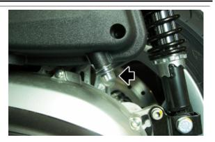
5. Operando dal lato destro del veicolo, rimuovere la fascetta per permettere di rimuovere il tappo per verificare la presenza di olio dovuto alla condensa dei vapori.
