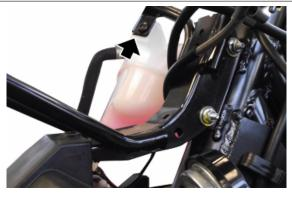
Operando sul lato destro del veicolo, svitare e togliere le due viti di fissaggio telaietto al cannotto di sterzo.
